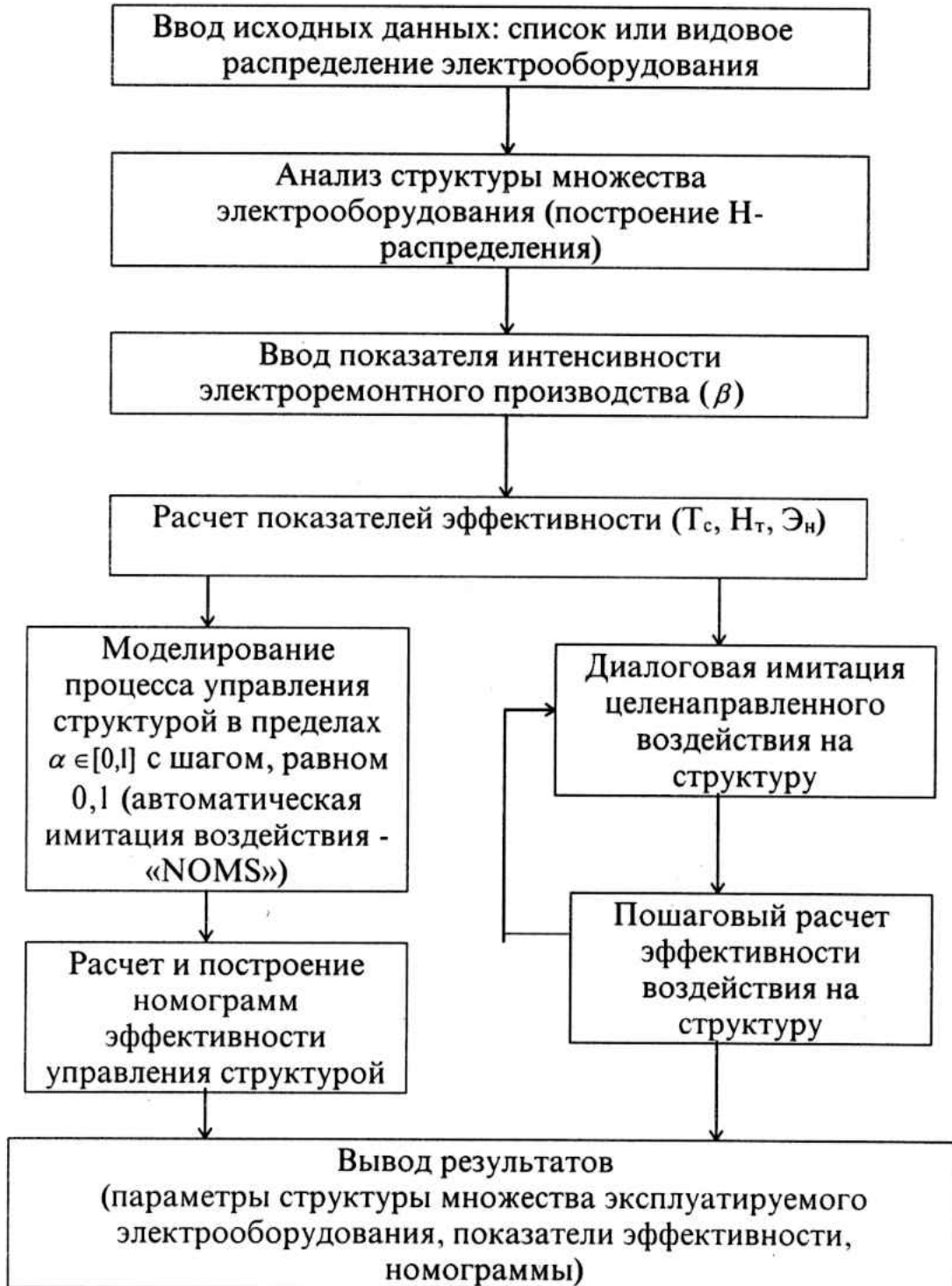
Рис. 6.2.1. Алгоритм имитационной модели управления видовой структурой множества эксплуатируемого электрооборудования «WID»
