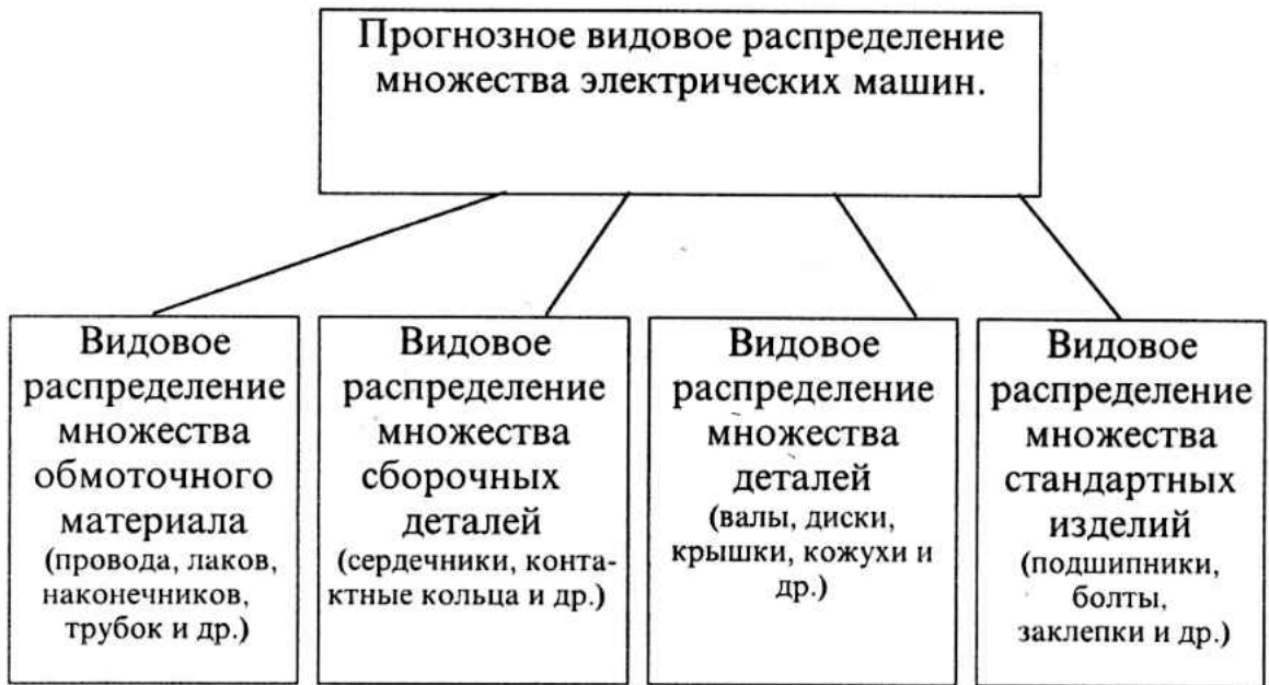
Рис. 6.3.2.1. Двухуровневая иерархическая модель видовой структуры множества электрических машин.
