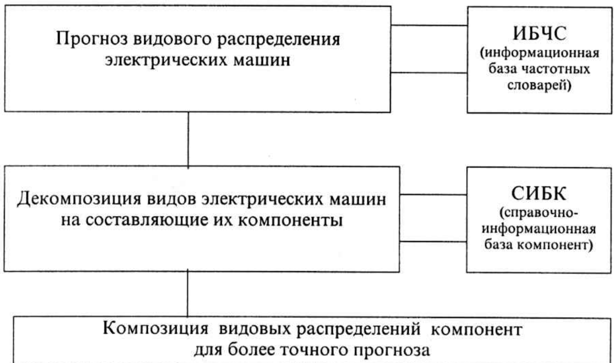
Рис. 6.3.2.2. Алгоритм программно-информационного обеспечения композиционной модели структуры эксплуатируемых электрических машин.
